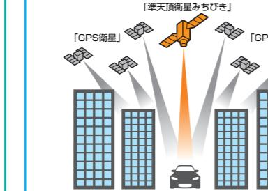
真上から電波を送る「みちびき」により、受信の難しいビルの谷間や山間部などで測位率が向上します。
