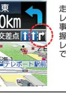
走行中の道路に専用レーンがある場合、事前に車線情報を把握して右/左折専用レーンを音声と矢印で案内します。
