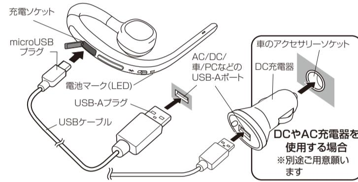
●USBプラグには差し込み方向があります。プラグ形状とポートの形状を確認してから無理せず慎重に差し込んでください。プラグ類を外す際には、必ずプラグの根元をしっかりと持って、水平にゆっくり抜いてください。
