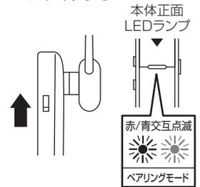
購入直後など、Bluetooth機器とペアリングされていない工場出荷状態は、イヤホンの電源をオンにするだけでペアリングモードになります。ペアリングモードになるとLEDランプが赤青交互点滅します (5分間継続)。ペアリングが成功するとLEDランプが消灯し、その後スタンバイモード (自動接続完了…約5秒間隔の青1回点滅) になります。5分間のペアリングモード中にペアリングが成功しなかった場合は、ピープ音が鳴りて自動で電源が切れるので、再度電源スイッチを切ってから入れ直し、もう一度ペアリングモードに戻してください。(→本書裏面「基本操作の説明」参照)
