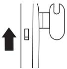
電源切の状態から電源スイッチを下から上にスライドすると電源が入ります。その後スタンバイモードになり、既に以前ペアリング済みの携帯電話が10m以内にあると、予めBluetooth機能を起動している状態であれば、相互で自動接続を試行します。
