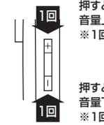
ボリュームアップ(VOL+)キーを押すと受話音量が上がります。ボリュームダウン(VOL-)キーを押すと受話音量が下がります。※音量は接続している携帯電話機のBluetooth音量設定と連動します。
