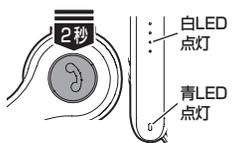
電源切の状態からメインスイッチを2秒押し続けると電源が入ります。青LEDが点灯して電源が入ります。その後スタンバイモードになり、既に以前ペアリング済みの携帯電話が10m以内にあると、予めBluetooth機能を起動している状態であれば、相互で自動接続を試行します。
