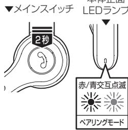
購入直後など、Bluetooth機器とペアリングされていない工場出荷状態は、イヤホンの電源をオンにするだけでペアリングモードになります。ペアリングモードになるとLEDランプが赤青交互点滅します (3分間継続)。ペアリングが成功するとLEDランプが消灯し、その後スタンバイモード (自動接続完了…約5秒間隔の青1回点滅) になります。3分間のペアリングモード中にペアリングが成功しなかった場合は、「パワーオフ」と音声案内して自動で電源が切れるので、再度電源スイッチを切ってから入れ直し、もう一度ペアリングモードに戻してください。(→本書裏面「基本操作の説明」参照)
