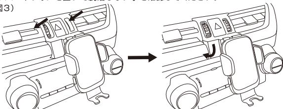
●取り外しの際は下側のツメを浮かせるようにして外してください。（図4）
