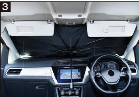
フロントガラスに合わせて位置を決め設置した後、サンバイザーを下ろし、固定してください。
