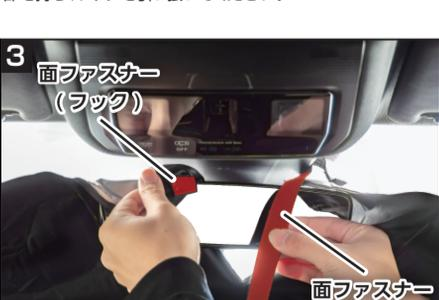
フロントガラスに合わせて位置を決め設置した後、面ファスナー同士をルームミラーの根本で固定するように留めてください。
