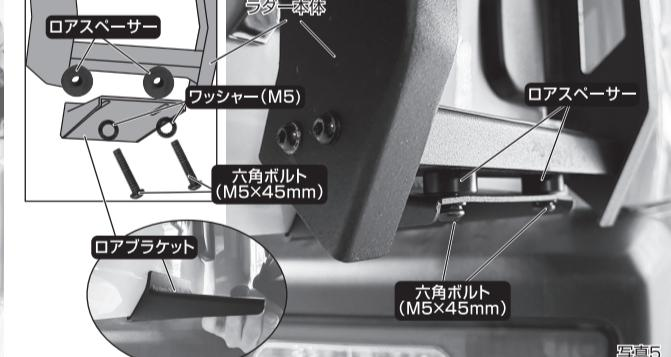
④上記で取り付けた製品本体を上に押し上げた状態でアッパープラケット(L)、アッパープラケット(R)を本締めし、ロアスペーザーが軽く潰れるくらいまで、ロアアラケットの六角ボルトを本締めし、ラダー本体と車体を固定してください。
