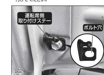
③下図の位置のボルトを10mmレンチで取り外し、同位置にワッシャーとボールボルトを12mmレンチで取り付けてください。(図3)
