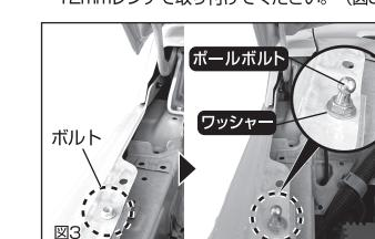
⑤運転席側ボンネットダンパーのジョイントBを車体に取り付けたボールボルトに上から押すように取り付けます。(図5)
