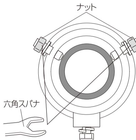
6 最後にコの字金具のボルトを六角スパナで締め付けて、完全に固定します。
