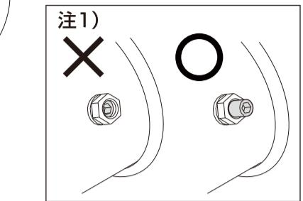
5 最初イモネジについている上2カ所のナットを六角スパナで締め付け、イモネジをしっかりと固定します。
