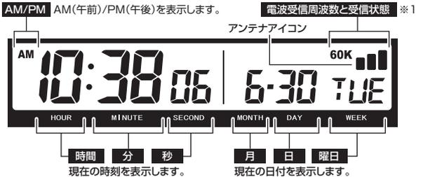
※1 電波受信中は点滅します（電波受信中は電波状況に応じてアンテナ表示が変化します）。電波受信に成功すると、受信した電波基地局の周波数が表示され、アンテナ3本が表示されます。受信に失敗した場合はすべて消灯します。
