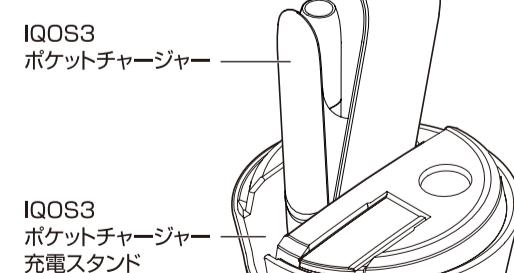
4 ●IQOS3ポケットチャージャーを差し込むと、吸い殻入れ口のLEDインジゲーターが白点滅します。点滅中は充電中です。
