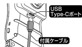
●ホルダー本体のUSB Type-Cポートに、付属のケーブルのUSB Type-Cプラグを接続してください。
