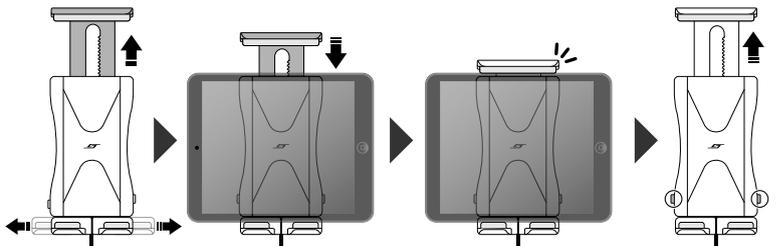
①通電後、上アームが自動で開きます。デバイスのサイズに合わせて、ステーの距離を手動で調整してください。
