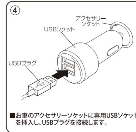
■お車のアクセサリーソケットに専用USBソケットを挿入し、USBプラグを接続します。
