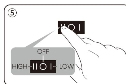
⑤ 本体背面のスイッチから風量を選び、押して作動させてください。
