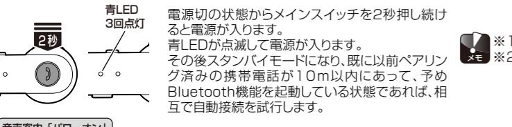
スタンバイモード(自動接続完了) → [LED] 接続時4回青点滅後、消灯
