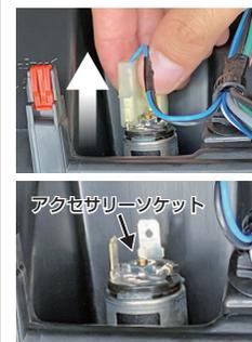
⑦パネル(C)裏側の純正アクセサリソケットに接続してある車両側の電源コネクターを外してください。
