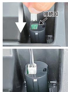
⑨接続した専用端子の反対側のコネクターを本体背面の接続口に押し込んでください。
