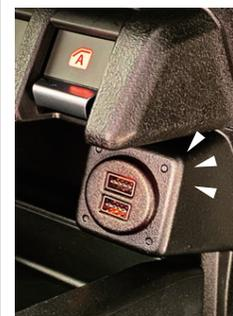
⑪キーをACCにして、本体の通電専用のLED照明、又は電圧表示が点灯するのを確認してください。
