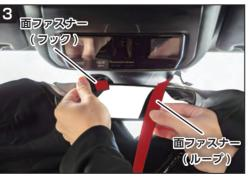
フロントガラスに合わせて位置を決め設置した後。面ファ スナー同士をルームミラーの根本で固定するように留め
