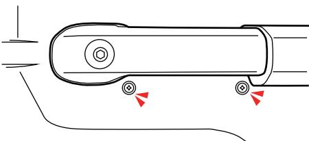
③製品裏側の矢印が車体前方向を向いていることを確認し、ネジを外したポイントに本体を合わせ、②で外したネジを共締めパーツに入れ、締めてください。
