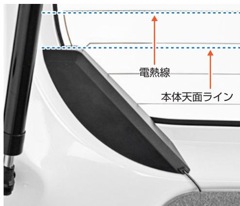
④ガラスの電熱線と本体天面が平行になるようにしながら、本体を車体形状に合わせるように位置調整してください。
