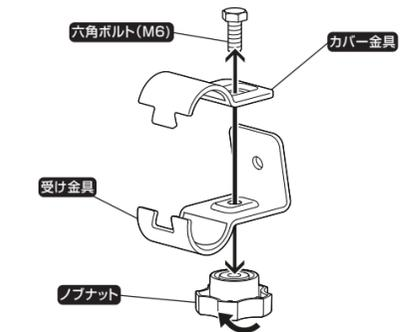
②受け金具を下図のように車体ネジ穴に取り付けます。取り付けの際はプラスドライバーをご使用ください。
