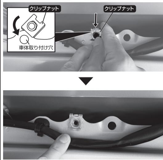
③④で車体取り付け穴に合わせてはめ込んだ4つのクリップナットに取り付けベースを合わせ、ボルトで固定します。
