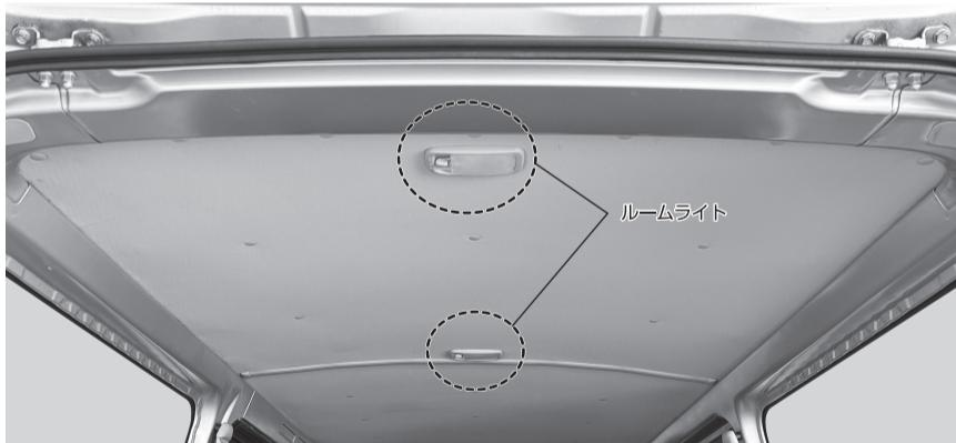
①カバー内側にある2箇所のボルトをプラスドライバーで取り外し、ルームライト本体を取り外してください。
