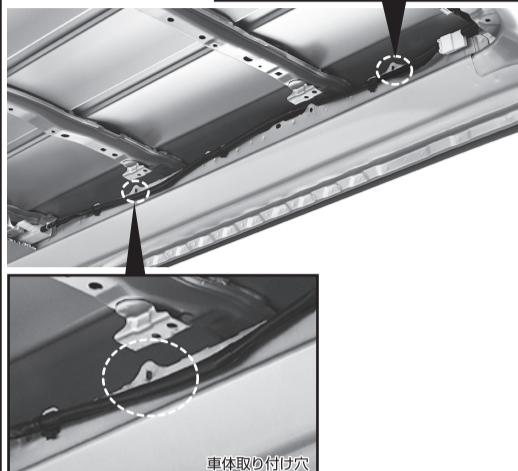
②クリップナットを下図のように車体取り付け穴に合わせてはめ込んでください。
