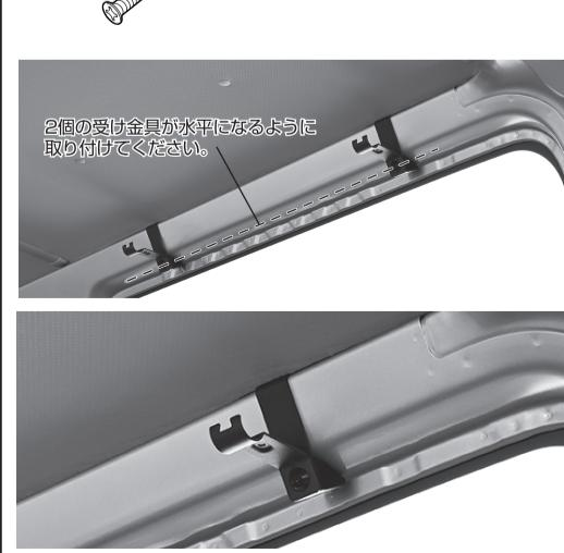
⑥受け金具を下図のように取り付けベースのネジ穴に取り付けます。取り付けの際はプラスドライバーをご使用ください。
