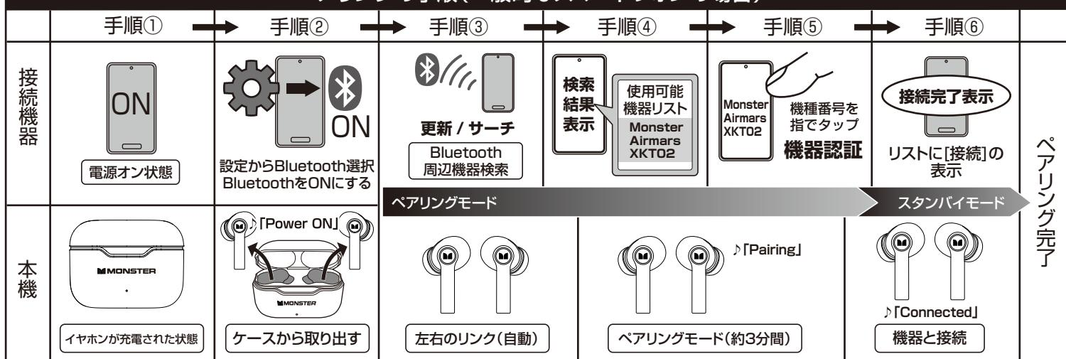
①本機と接続機器(Bluetooth対応機種/電源オン状態)を手元(30cm以内の距離を推奨)に置いて準備します。
