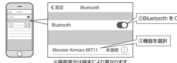
④ペアリングが完了すると「Connected(コネクテッド)」のアナウンス音が流れ、携帯電話などの端末に表示されるBluetooth接続機器リストの中で【Monster Airmars XKT11】が接続中の状態になります。
